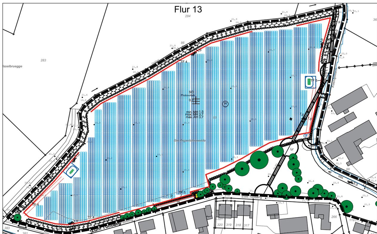
Abb. 3: Übersicht über die vorgesehene Anlagenkonfiguration im Plangebiet
