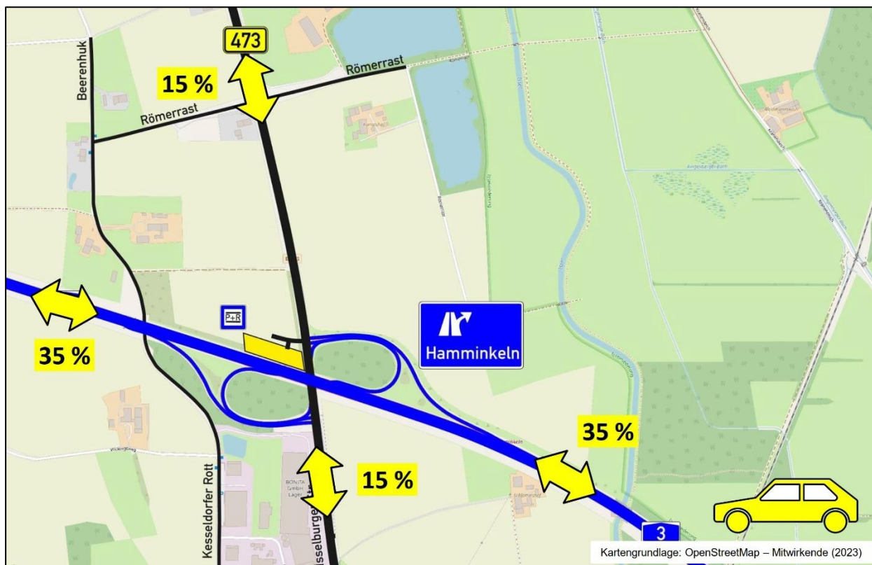
Abbildung 19: Räumliche Verteilung des Neuverkehraufkommens P+R-Anlage (Kartengrundlage: OpenStreetMap-Mitwirkende [1])
